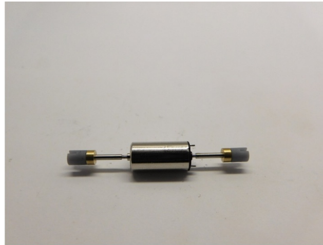
Kardankupplungen platzieren Mount the cardan couplers Monteer de kardankoppelingen
