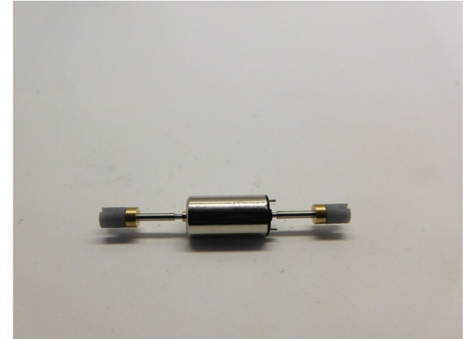
Kardankupplungen platzieren Mount the cardan couplers Monteer de kardankoppelingen
