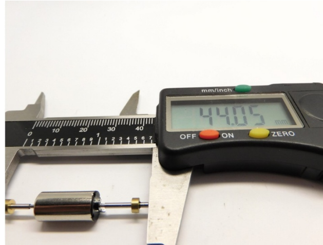
Maße prüfen Check dimensions Controleer de maatvoering
