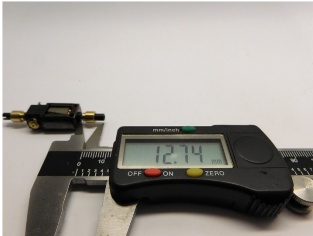
Maße prüfen Check dimensions Controleer de maatvoering
