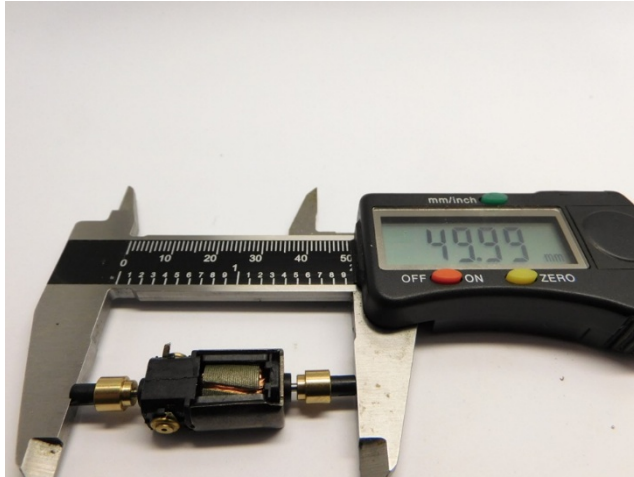
Maße prüfen Check dimensions Controleer de maatvoering
